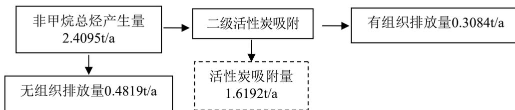
图2-2 VOCs（以非甲烷总烃计）物料平衡图
